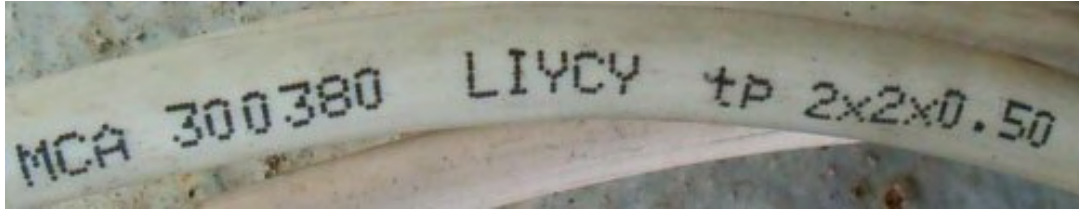
( 2 \times 2 sodrot érpár, 0.5\text{mm}^2 -es keresztmetszettel)
